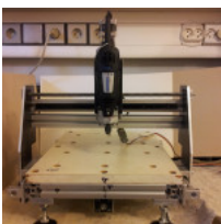
Testování svislého posunu
