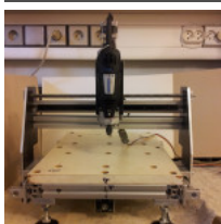
Testování svislého posunu
