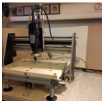
Vyrovnání a testování vřetene
